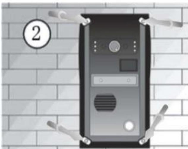
2. Seleccione una ubicación para la cámara exterior. Y fije 4 tornillos en 4 agujeros en la pared con el tarugo y caja interior.
