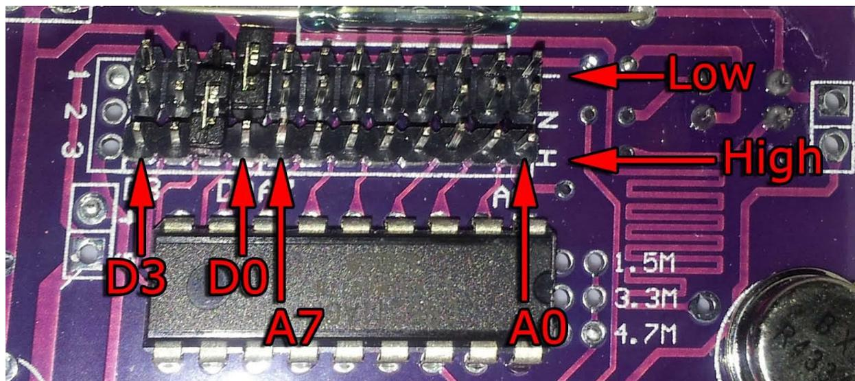
Después de haber colocado los jumpers, procedes a emparejar la alarma con los sensores. Hay veces que los sensores vienen ya con sus jumpers, esto solo te ahorraria el trabajo.
