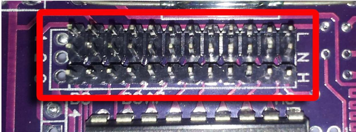
Primero debes colocar 2 jumpers como se ve en la imagen siguiente, en la posición D0 en LOW, y D1 en High, luego coloca de 4 a 7 jumpers en posiciones aleatorias entre la posición A7 y A0 para darle su identidad, esta segunda serie de jumpers no debe ser similar en los sensores en ningún caso, ya que si esto sucede, la alarma no va a poder diferenciar los sensores.
