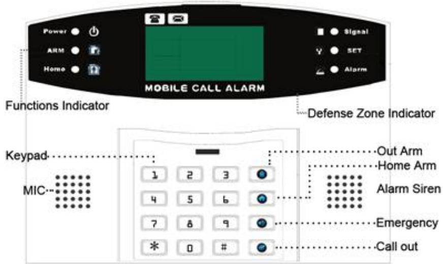
Panel de alarma back diagrama esquemático:
