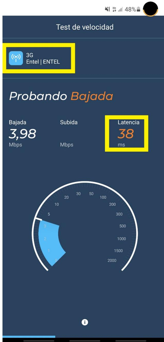
En el siguiente ejemplo se muestra la prueba ya realizada de manera completa, con el 3G de Entel, los datos indican 4,02 mbps de bajada, subida de 0,355 mbps y la latencia 38ms, como antes se mencionaba debe probar en diferentes horarios para tener un promedio o una media a los valores que le entregan las aplicaciones.
