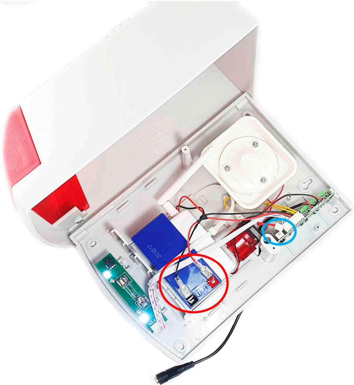
**Imagen 3, muestra la conexión de la batería.**
